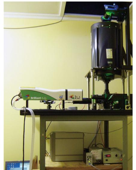
写真2. 改良を施したライダー装置。
