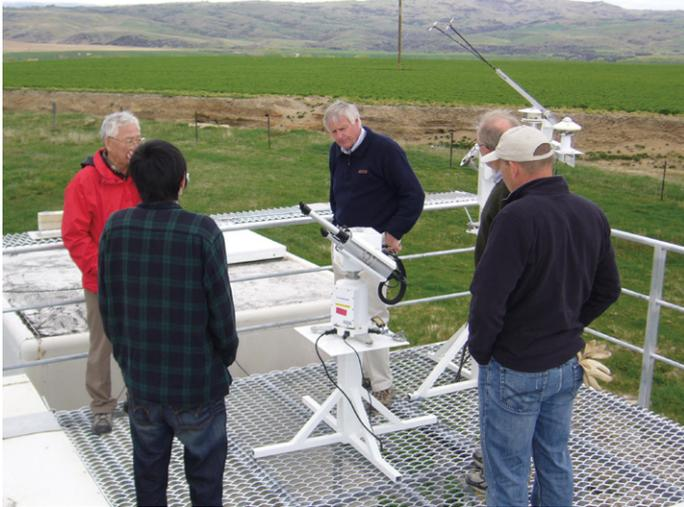
写真3. ローダー大気研究観測所の光学観測室 (Optics Lab.) 屋上に設置されたスカイラジオメーター。写真: 永井 智広
