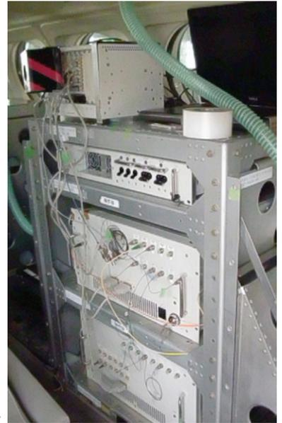
写真2. 機内に設置したレーザーを用いたCO<sub>2</sub>測定装置。短波長赤外域のレーザーを窓を通して地表面へ照射し地表面散乱光を望遠鏡で受けて、飛行機と地表面の間のCO<sub>2</sub>量を測定します。写真：境澤大亮
